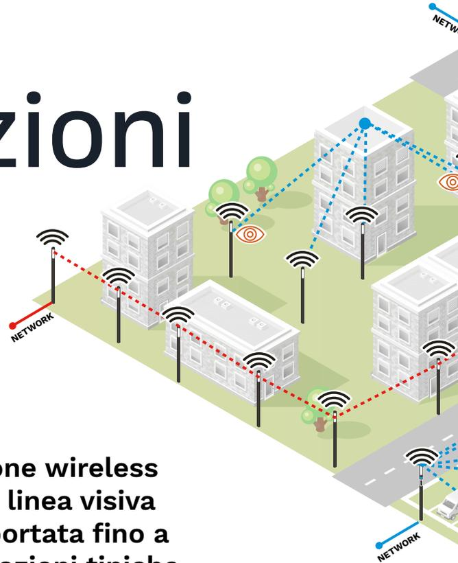
Gli SHUFFLE dotati di moduli di connessione wireless comunicano entro un raggio di 90° su una linea visiva senza ostacoli tra i diversi nodi, con una portata fino a 400 metri. Sono possibili quattro configurazioni tipiche.
